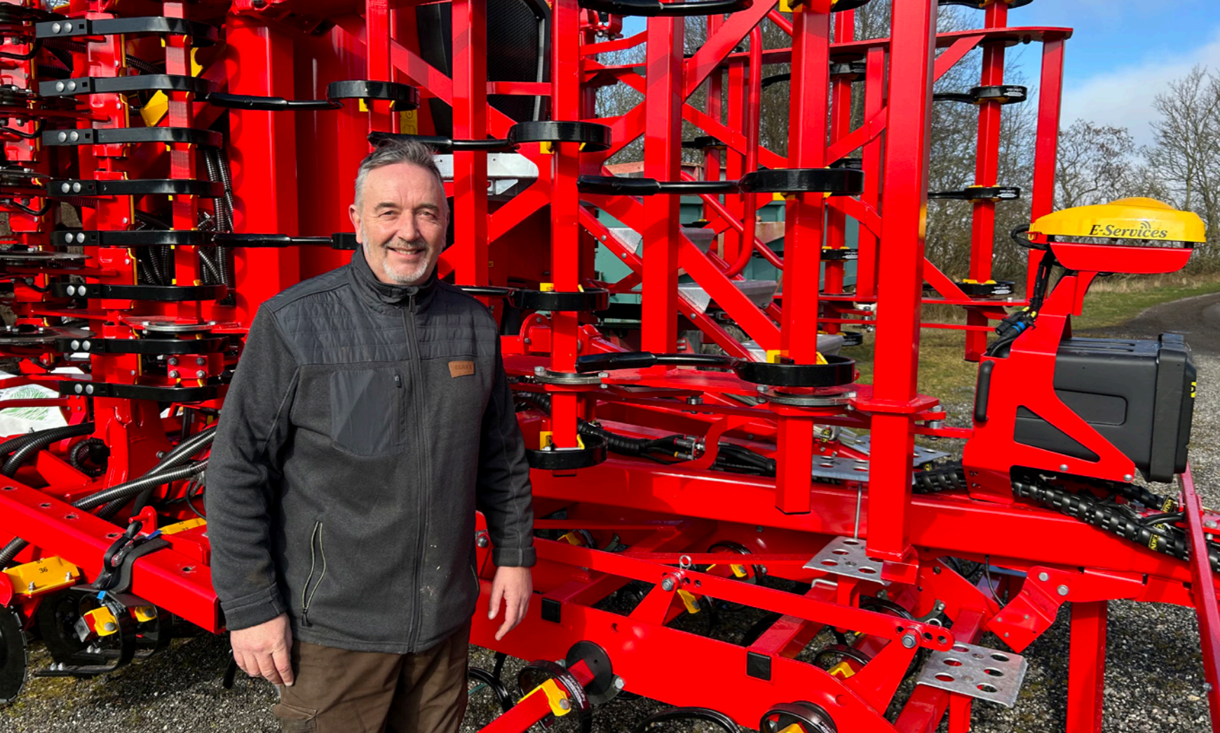
Lars Schandorff er glad for Väderstads såprincip, hvor kernen placeres ved tallerkenskæret, så såkornet kan komme godt i jorden.
